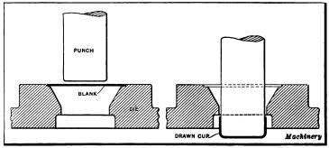
Fig. 6. Simple Type of Drawing Die
